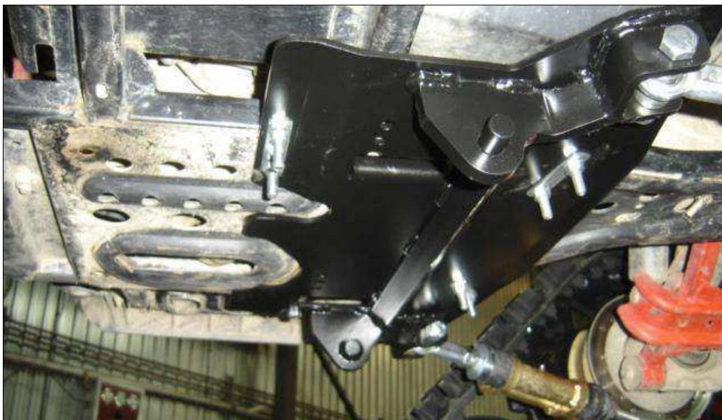
En servant des trous oblongs comme guide, percer la structure ou nécessaire avec une mèche 11/32".
