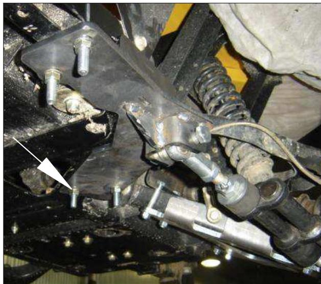
Fixer solidement sur la structure la pièce 03PA-267G.
