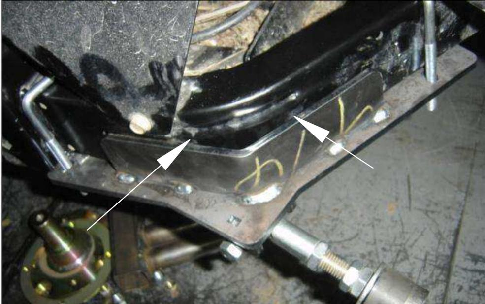
Appuyer la partie en L sur le coin de la structure.
